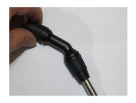
7. 不同鬆緊度可調整不同噴水方式 (調整時另一手需握住下螺帽)
